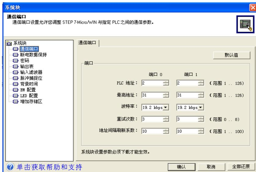
在本例中：端口 0：电脑与 PLC 连接用端口参数。
