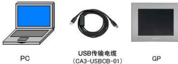
(1) 用数据传输 USB 电缆连接 PC 和 GP-4301TW(电缆型号：CA3-USBCB-01)。
