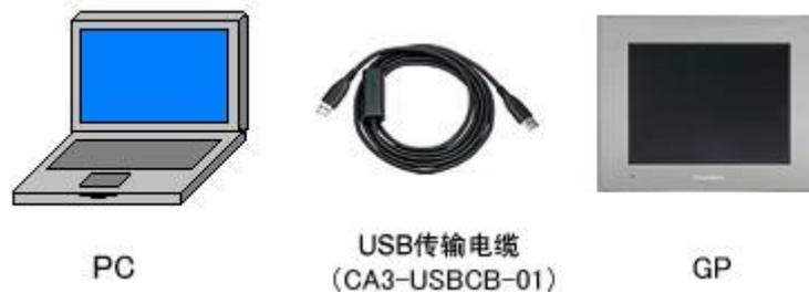
(1) 用数据传输 USB 电缆连接 PC 和 GP-4301T/TW(电缆型号：CA3-USBCB-01)。如果 PC 上没有安装传输电缆的驱动程序，则会弹出一个对话框。请按照指示进行操作。
