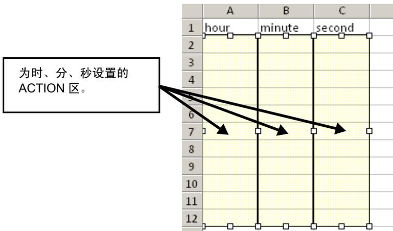
上图显示了几个 ACTION 区，它们从外接控制器的时钟寄存器中读取时、分、秒数据，并将数据填入列 A、B、C。A、B、C 各列分别设置了不同的 ACTION 区。
