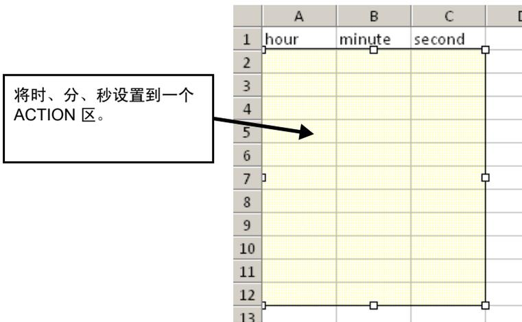
上图显示了几个 ACTION 区，它们从外接控制器的时钟寄存器中读取时、分、秒数据，并将数据填入列 A、B、C。A、B、C 列被设置到一个 ACTION 区。在 [Execution Sequence List] 画面中，设置一个触发条件用于运行一个 ACTION 区。
