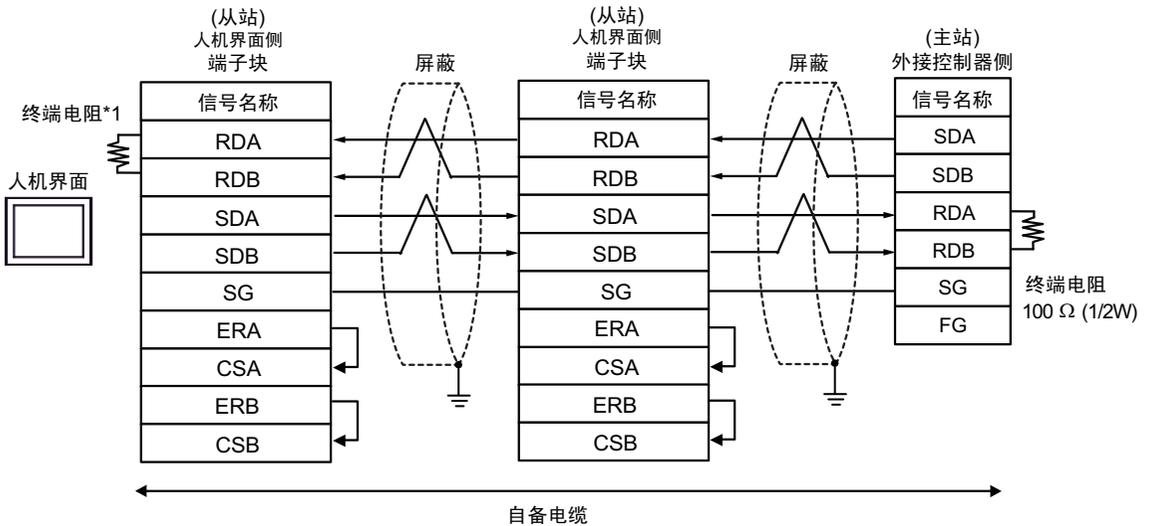
\*1 人机界面中的电阻被用作终端电阻。如下表所示设置人机界面背板上的 DIP 开关。
