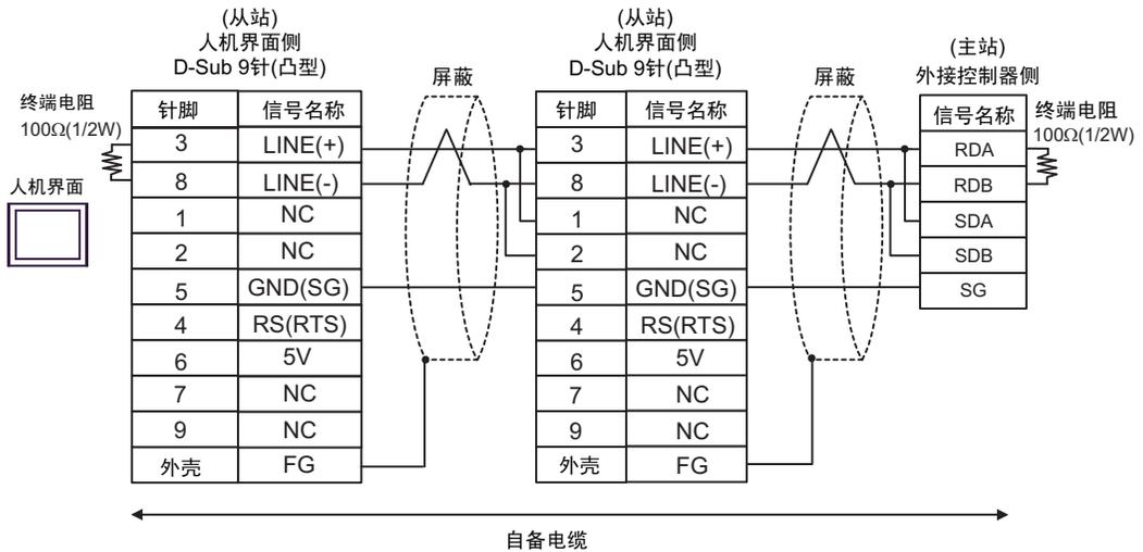
**重要** • 人机界面上的 5V 输出 (6 号针脚) 是西门子 PROFIBUS 接头的电源。请勿将其用于其他设备。
