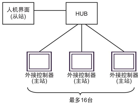
最多可连接 16 台外接控制器 (主站)。
