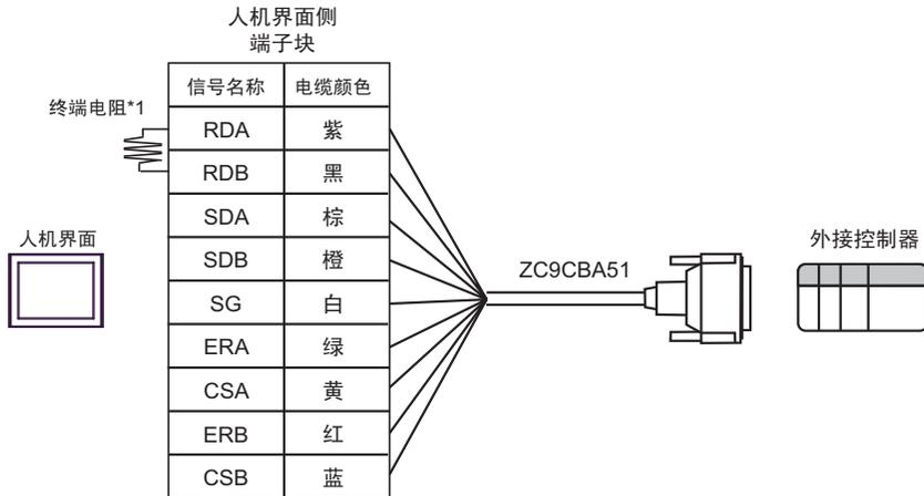
\*1 人机界面中的电阻被用作终端电阻。如下表所示设置人机界面背板上的 DIP 开关。
