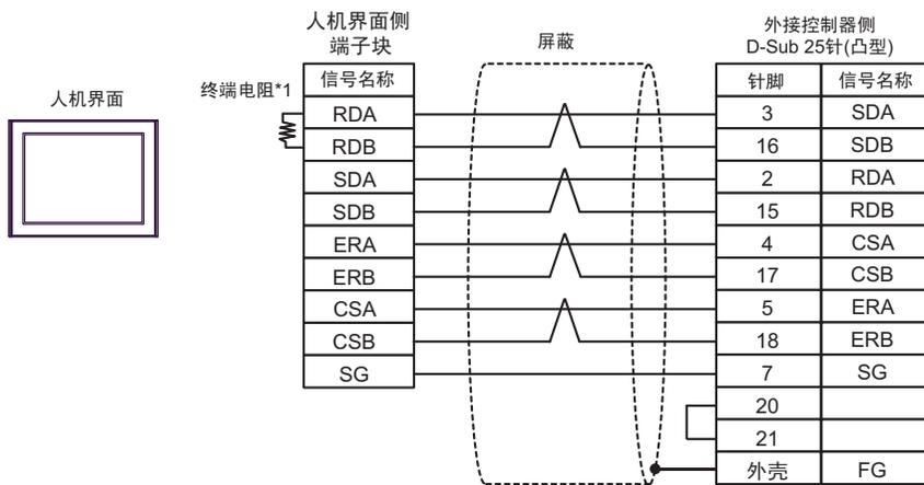
\*1 人机界面中的电阻被用作终端电阻。如下表所示设置人机界面背板上的 DIP 开关。
