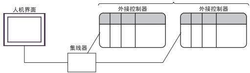
\*1 采用 UDP 连接时最多可连接 32 台 PLC ,采用 TCP 连接时最多可连接 16 台 PLC 。
