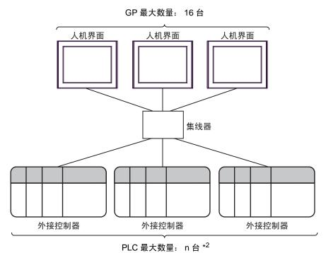
\*2 采用 UDP 连接时最多可连接 32 台 PLC ,采用 TCP 连接时最多可连接 16 台 PLC 。
