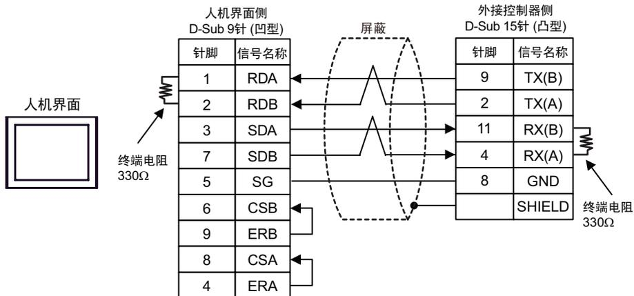
**注 释** • 当使用 50m 或以上长度的电缆时建议加装终端电阻。
