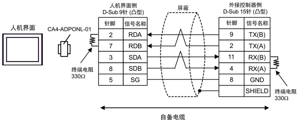
**注释** • 当使用 50m 或以上长度的电缆时建议加装终端电阻。
