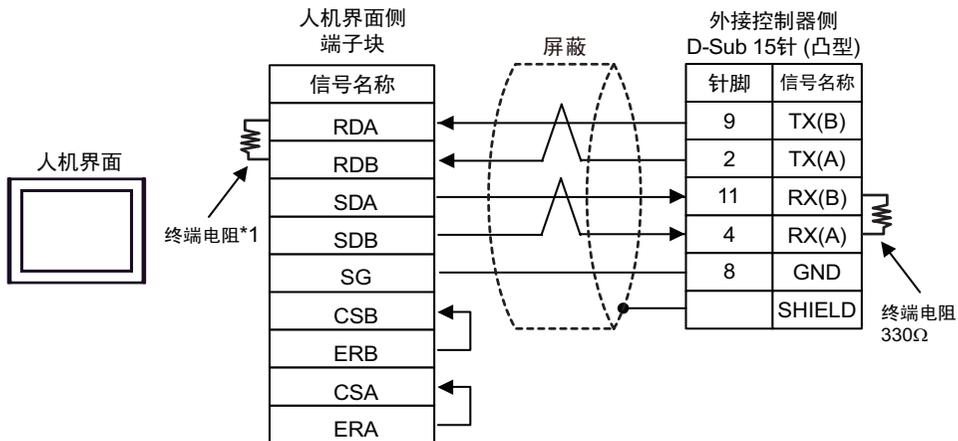
**注释** • 当使用 50m 或以上长度的电缆时建议加装终端电阻。
