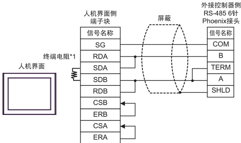
\*1 人界面中的电阻被用作终端电阻。如下表所示设置人界面背板上的 DIP 开关。
