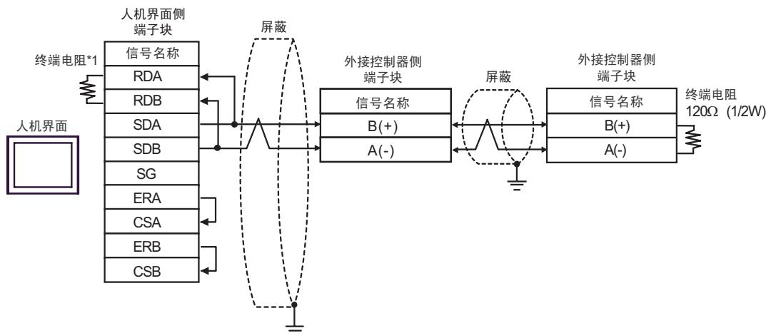
\*1 人机界面中的电阻被用作终端电阻。如下表所示设置人机界面背板上的 DIP 开关。
