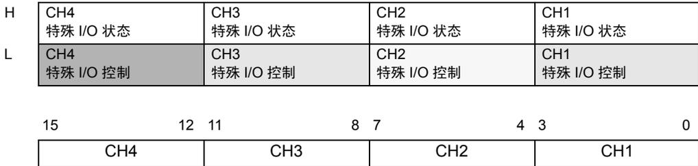
将 CH 的开始位 (0 位) 置 ON 来开始输出，将它置 OFF 来停止输出。
