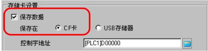
3 [ 控制字地址 ] 控制着向 CF 卡的数据写入。
