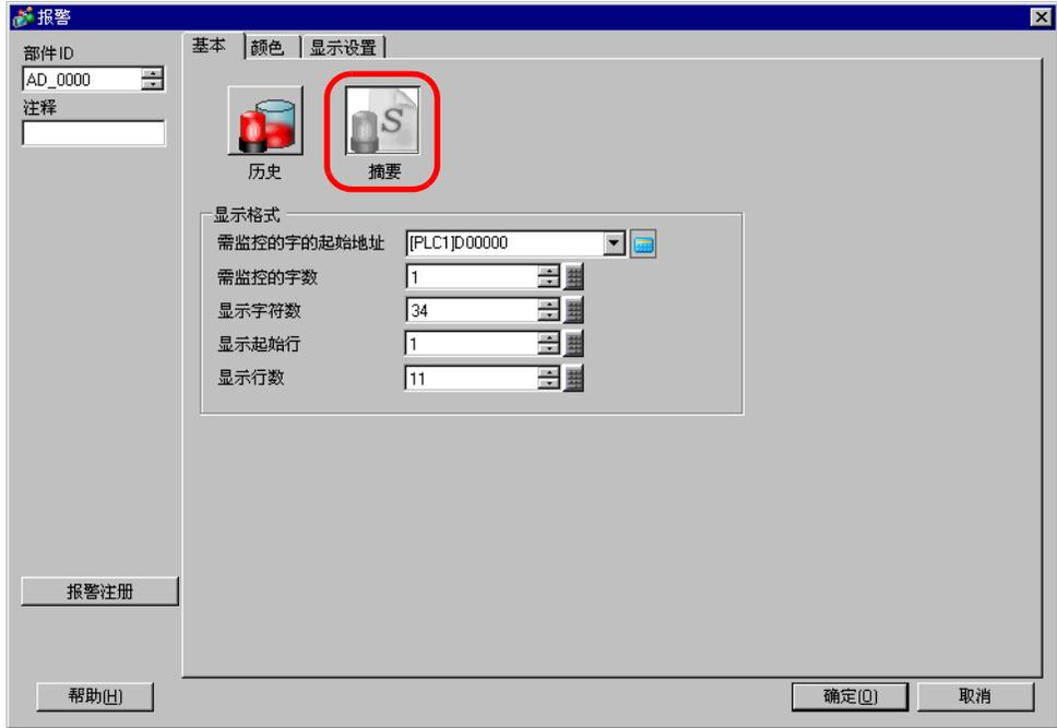
8 在 [需监控的字的起始地址] 中，使用一个被转换为 16 位字的值，来设置已经在 [报警] 中注册的位地址的起始地址。
