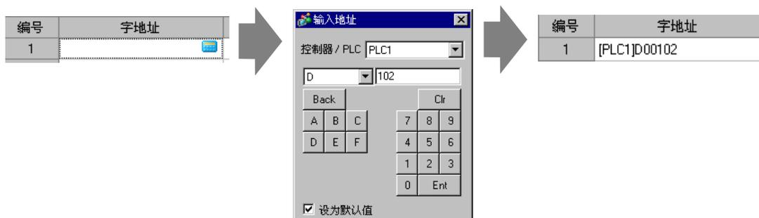
7 点击 [ 启动条件 ] 单元格，然后点击 。此时显示 [ 触发条件设置 ] 对话框。
