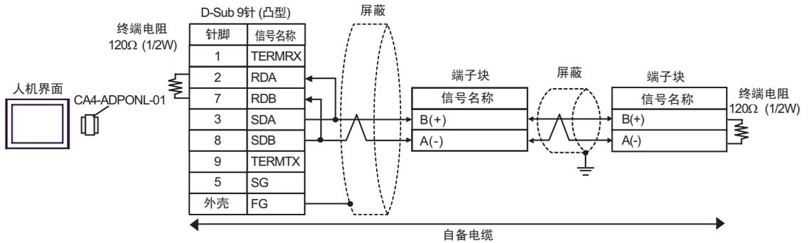
E) 当使用 Pro-face 制造的串口转换适配器 (CA3-ADPCOM-01) 和 RS-422 转换适配器 (CA3-ADPTRM-01) 时
