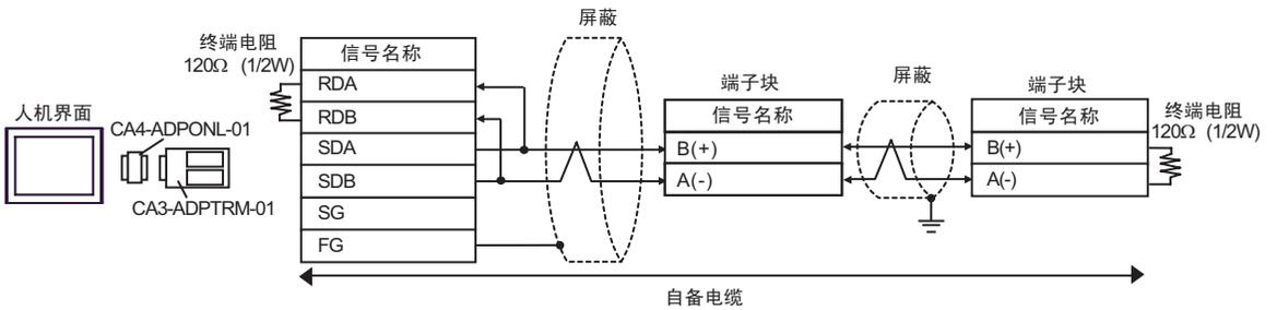
D) 当使用 Pro-face 制造的串口通讯终端适配器 (CA4-ADPONL-01) 和自备电缆时
