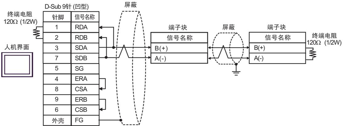
C) 当使用 Pro-face 制造的串口通讯终端适配器 (CA4-ADPONL-01) 和 RS-422 转换适配器 (CA3-ADPTRM-01) 时
