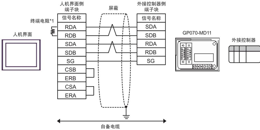
\*1 人机界面中的电阻被用作终端电阻。如下表所示设置人机界面背板上的 DIP 开关。
