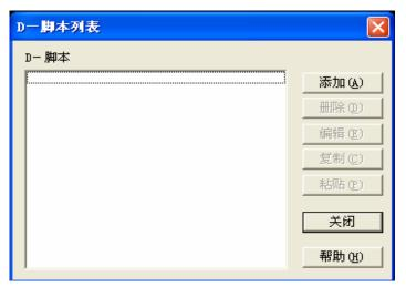
点击"D脚本列表"中的[添加]。在显示 D脚本编辑器后,在"D脚本工具箱"中输入"地址"和"运算符"等。最后点击[确定]进行注册。
