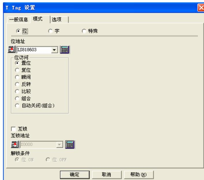
B: 设置数值输入的触发 (T-tag 设定地址: LS8186的04位)
