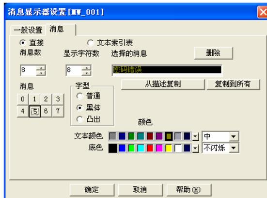
D: 设置键盘和K-tag（触发地址：LS8186的03位 字地址：LS8187）来输入密码。但K-tag 放放置在画面以外， 这样当输入密码的时显示\*号。
