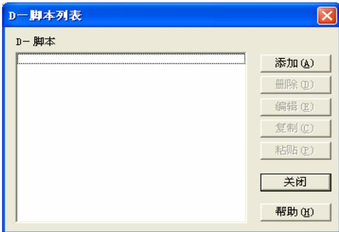
在D脚本列表窗口内, 单击[增加]按钮, 弹出D脚本编辑器窗口。通过D脚本工具箱操作输入地址和函数。单击[确定]进行保存。
