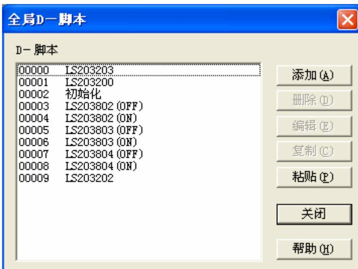
创建好的 D 脚本注册在脚本列表中。如需编辑已有的 D 脚本，请选择脚本的名称，然后点击[编辑]，或双击该脚本名称，直接打开 D 脚本程序。
