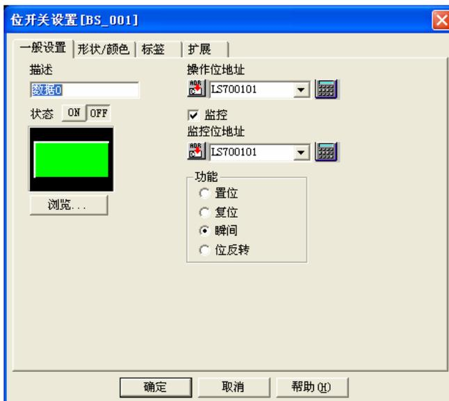
触摸该按钮，LS700101 位将置 ON。当 LS700101 被置 ON 时，将执行 D 脚本“00002（数据清除）”。
