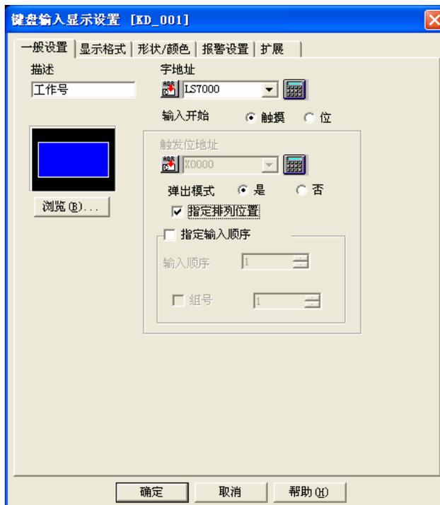
设置一个存储从 CSV 文件中读出的工作号的部件 (行号)。触摸“键盘输入显示”时, 会显示一个键盘 (数字键盘), 而当触摸“ENT”键时, 工作号将被保存到 LS7000 地址中。
